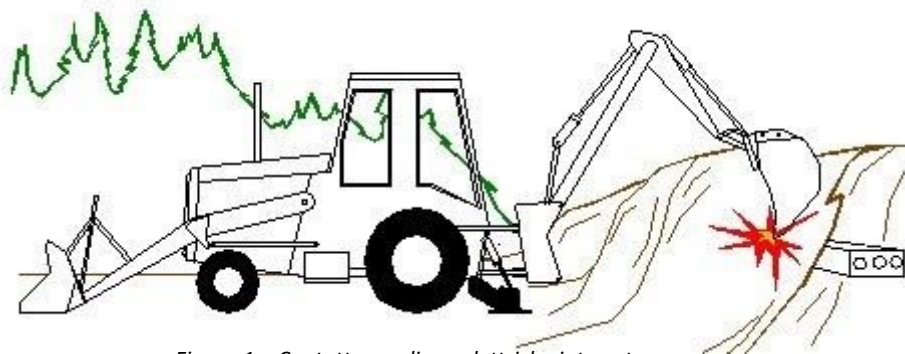
Figura 1 – Contatto con linee elettriche interrate
