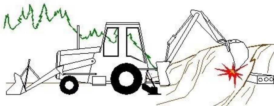
Figura 1 – Contatto con linee elettriche interrante
